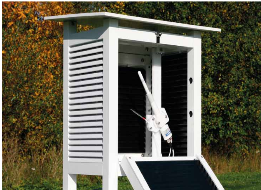
HMP155 kiegészítő hőmérséklet érzékelővel és opcionális hőmérőház telepítő szettel
